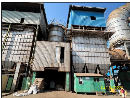
ภาพที่ 2.17 การลำเลียงฝุ่นจากระบบดักฝุ่นแบบถุงกรอง (Bag Filter) ขึ้นรถบรรทุกเพื่อส่งไปกำจัด
