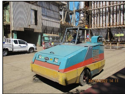
ภาพที่ 2.7 รถดูดฝุ่นและพ่นงานทำความสะอาดพื้นถนนบริเวณเส้นทางขนส่งวัตถุดิบ
