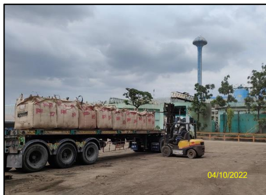
ภาพที่ 2.17 การลำเลียงฝุ่นจากระบบดักฝุ่นแบบถุงกรอง (Bag Filter) ขึ้นรถบรรทุกเพื่อส่งไปกำจัด
